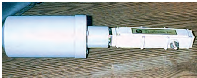
1 - Antenne hélice dans le radôme de la parabole N3IYR.
