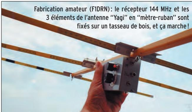
Fabrication amateur (F1DRN) : le récepteur 144 MHz et les 3 éléments de l'antenne "Yagi" en "mètre-ruban" sont fixés sur un tasseau de bois, et ça marche!
