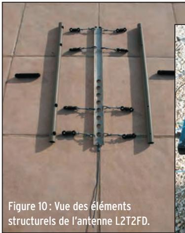
Figure 10: Vue des éléments structurels de l'antenne L2T2FD.
