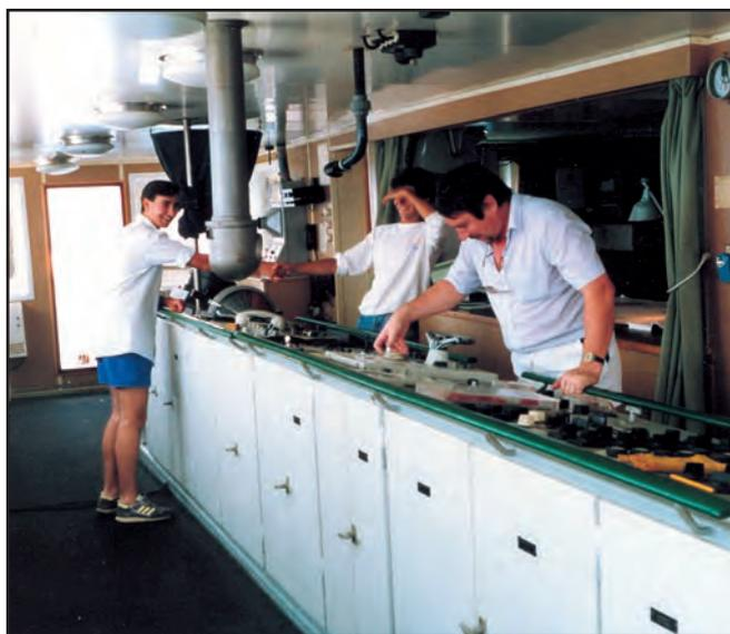
Photo 3 : Pilote automatique, réglage du changement de route.
