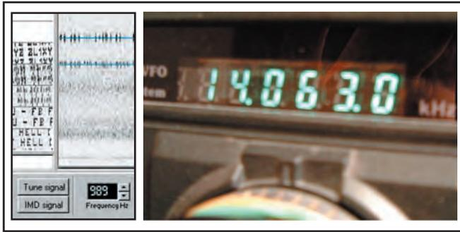
Fig. 2 et Fig. 3 : Réception DUPLO avec Hellschreiber de IZ8BLY, la fréquence indiquée correspond à la tonalité la plus basse, on voit clairement le shift de 245 Hz.
