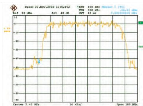
L'occupation spectrale de toute la bande WIFI par un poste client configuré en mode "sniffer" sur tous les canaux potentiels pendant toute la durée de l'analyse (mesure et photo: FITE).
