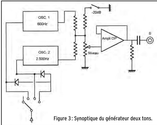
Figure 3: Synoptique du générateur deux tons.
