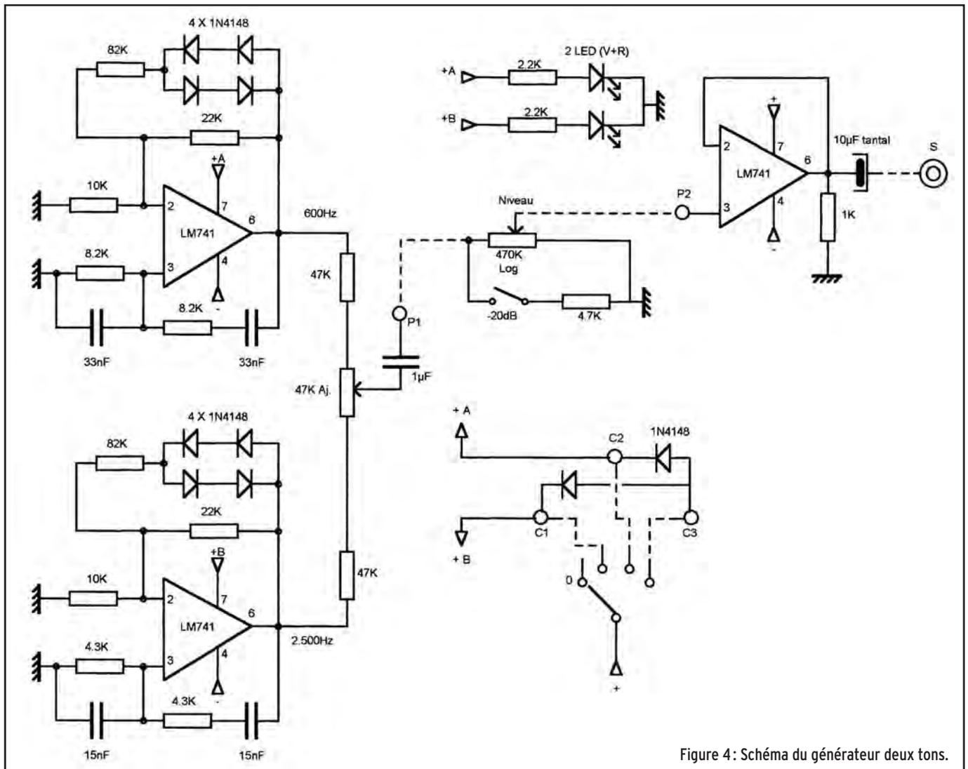
Figure 4: Schéma du générateur deux tons.
