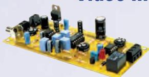
Inséré dans un ensemble en circuit fermé (TVCC), ou simplement raccordé à une mini-caméra CCD, cet appareil permet, à peu de frais, de détecter une intrusion, un mouvement ou un changement d'éclairage dans un local surveillé.
