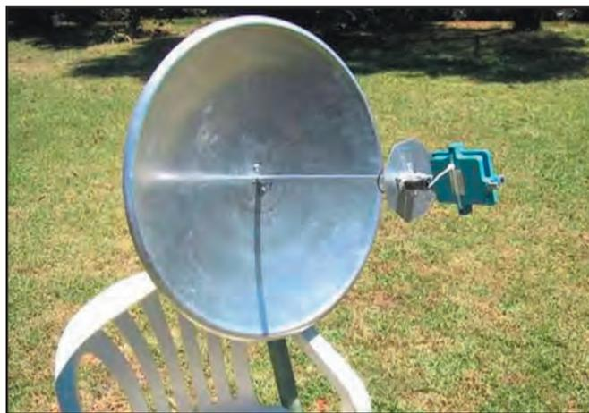
Figure 6 : Antenne parabolique avec Drake pour réception AO-40.
