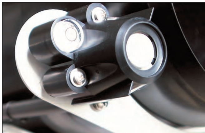
Le capteur UV : on voit les vis de réglage de l'assiette et le niveau à bulle.
