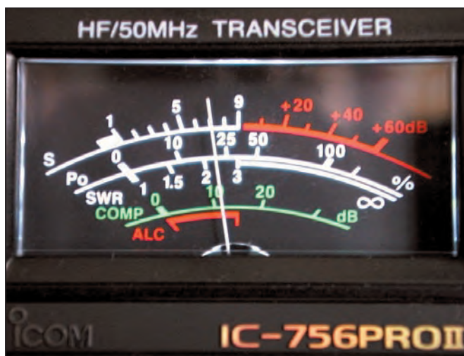
Un Smètre calibré à 3 dB par point.
