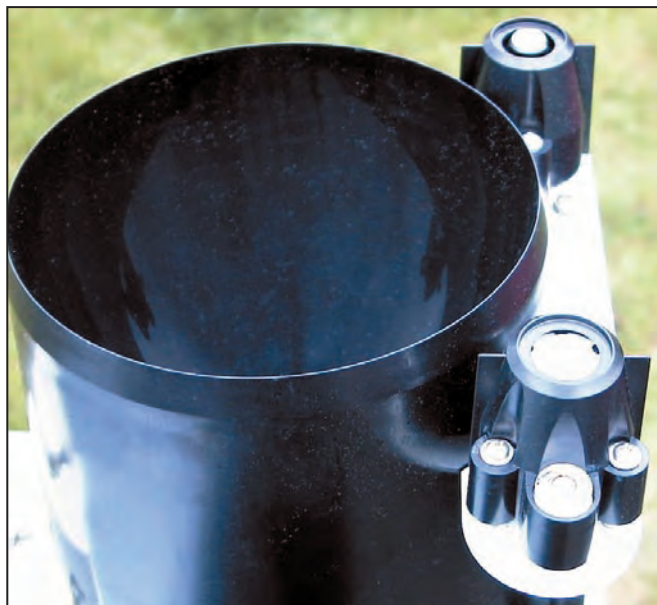
Le pluviomètre et les capteurs solaires.
