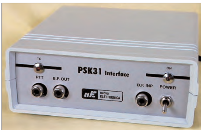
L'interface et son alimentation tiennent dans un petit boîtier.
