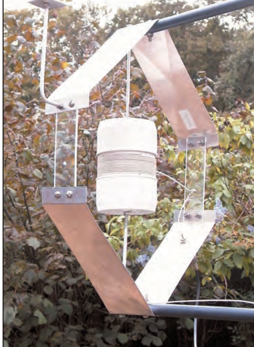
Vue de l'antenne assemblée, dispositif de réglage monté.
