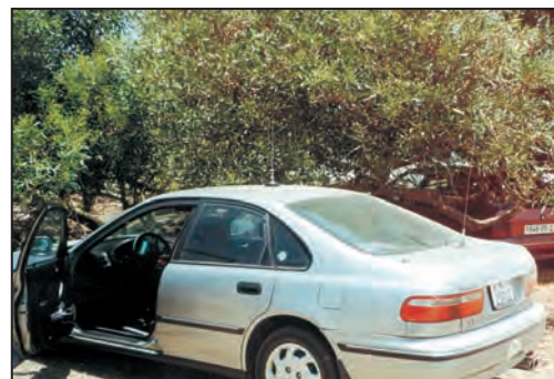
La 1/4 λ 6m sur le coffre, la 1/4 λ 2m sur le toit.
