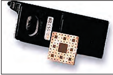
Figure 7 : Une antenne fractale en circuit imprimé, destinée à être montée à l'intérieur du téléphone portable. (Document communiqué par Nathan Cohen NIIR).
