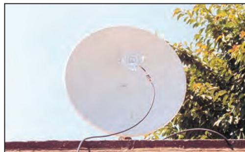
Photo 12 : LNBY monté au foyer d'une parabole. On remarque l'ampli de ligne BIS.
