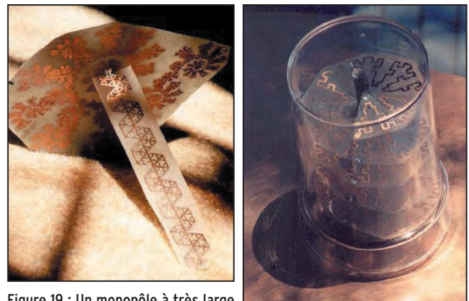
Figure 20 : Une antenne hélice miniaturisée grâce à la fractalisation. Nathan Cohen NIIR.
