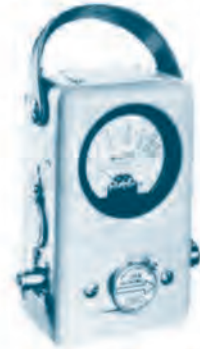
Boîtier BIRD 43 450 kHz à 2300 MHz 100 mW à 10 kW selon bouchons tables 1 / 2 / 3 / 6
