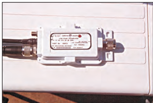
Photo 5 : Préalimentateur à large bande.
