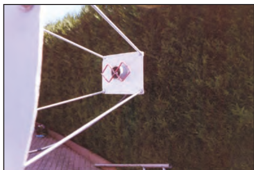
Photo 6 : Vue de la double-quad, ici en source.
