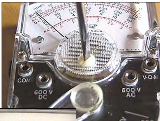
Photo 1 - Mise à zéro de l'aiguille.
