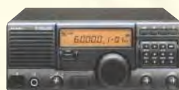
System 600 Emetteur/récepteur HF base/mobile 100 canaux — 150 W
