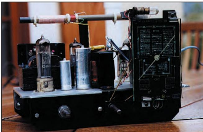
La self réalisée tel qu'indiqué sur la figure 2 permet de couvrir la totalité de la gamme des grandes ondes. Dans le circuit d'anode du tube EF80, j'ai utilisé une self de choc de type R100 pour bloquer la HF. A défaut, cette dernière peut être remplacée par une résistance d'environ 100 kΩ sur laquelle on aura bobiné une centaine de spires de fil émaillé (diamètre 0,1) soudé aux 2 extrémités de la résistance.
