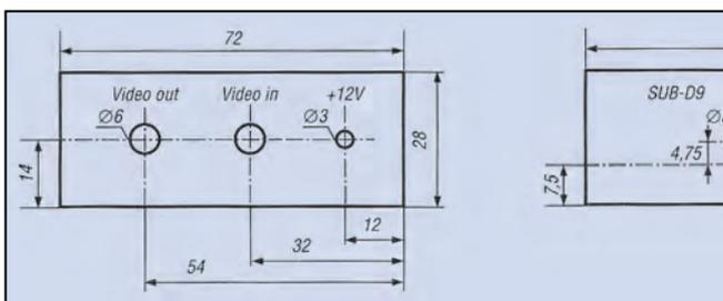
Figure 5 : Plans de perçage.
