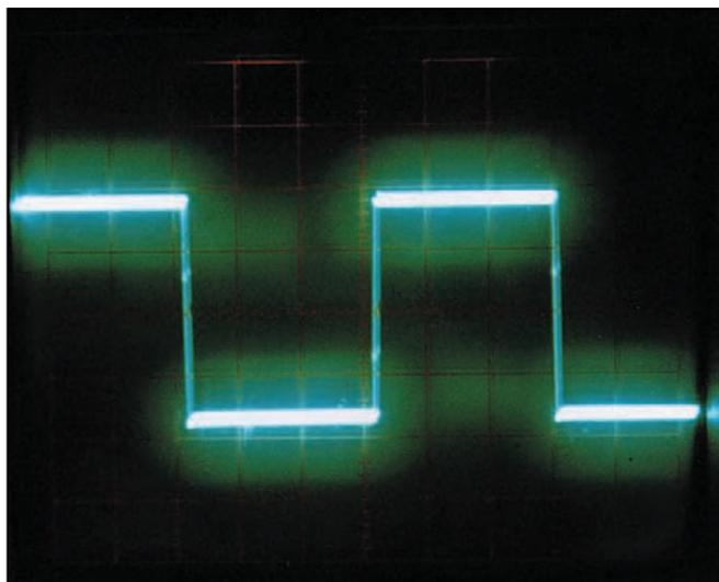
tude est de 30 V CC pour le signal carré et de 4 V CC pour le signal triangulaire (pour des tensions d'alimentation de + et - 15 V). A titre indicatif, c'est ce genre de circuit que j'utilise pour le balayage dans mon analyseur de spectre (et également dans le wobulateur récemment décrit dans MEGAHERTZ).
