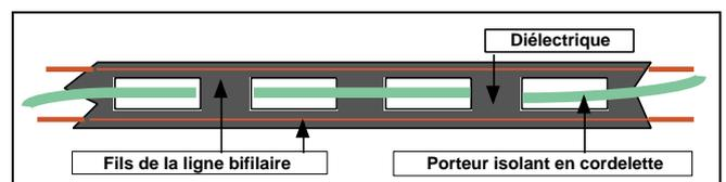
Figure L12 - Porteur pour twin-lead 450 ohms.
