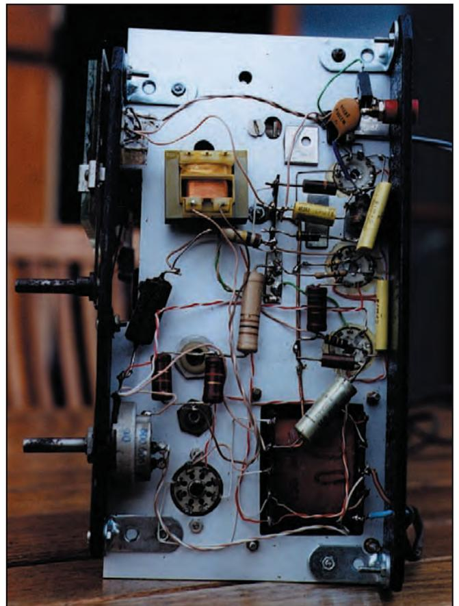
d'un circuit RC classique. Ne disposant pas de self de filtrage pour L2, j'ai tout simplement utilisé un transformateur miniature 220/12 V, c'est l'enroulement primaire qui fait office de self de filtrage.
