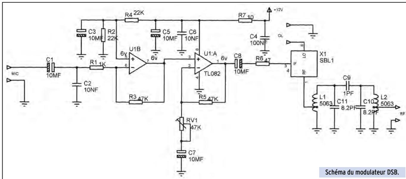
Schéma du modulateur DSB.
