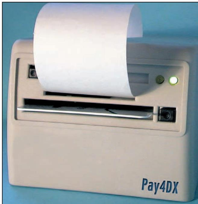
s'éclaire, indiquant que Pay4DX est prêt pour la transaction. La transmission radio (format numérique particulier) dure une fraction de seconde (très exactement 200 ms) et un accusé de réception de l'opérateur DX est transmis dans le même temps. L'émission-réception de ces deux trames est accompagnée par l'allumage d'une LED jaune.
