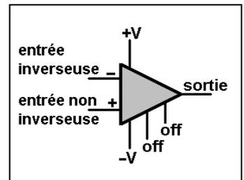
Figure 2 : Symbole d'un amplificateur opérationnel.
