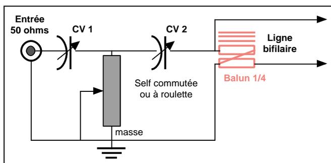
Figure L14 - Schéma de la boîte d'accord ci-dessus.
