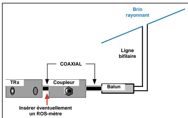
Figure L13 - Boîte d'accord (ou coupleur) de l'OM fatigué.
