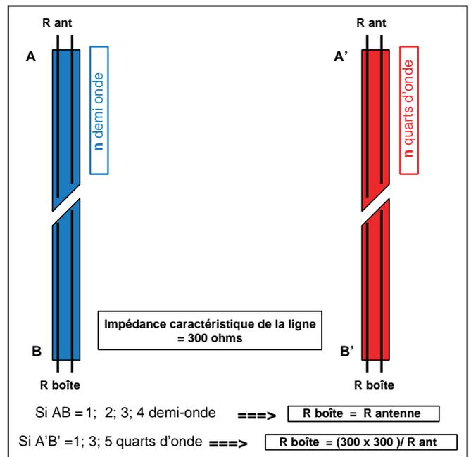
Figure L11 - Comment, à cause de sa longueur, une ligne peut modifier l'impédance à l'autre extrémité de la ligne.
