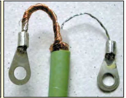
Les coax d'adaptation seront terminés par des cosses.
