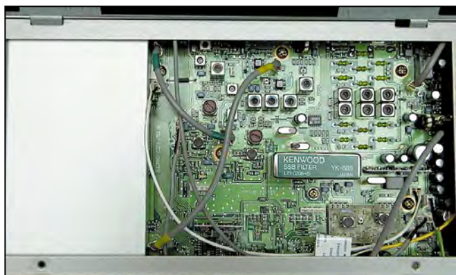
Une trappe facilite l'installation du filtre à quartz optionnel.
