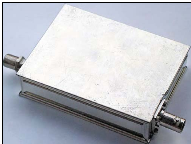
Figure 15 - Convertisseur abaisseur pour la bande 1,9 GHz.
