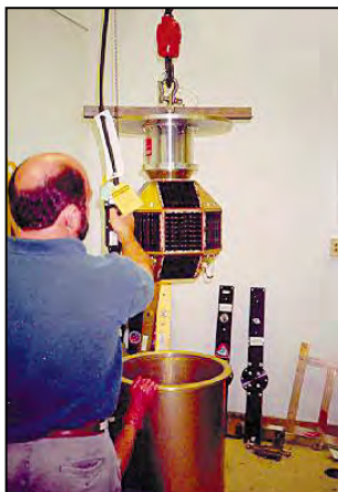
PANSAT en cours de montage.
