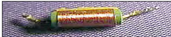
Photo 5 - Une self de choc bobinée sur une résistance.
