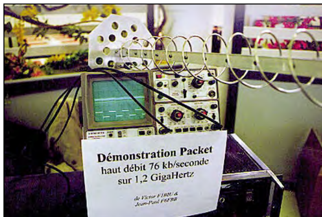
Les signaux carrés représentent l'horloge 76 kHz RX reconstituée par le modem côté TX. L'antenne hélice pointée sur l'émetteur. © Photo F6BVP
