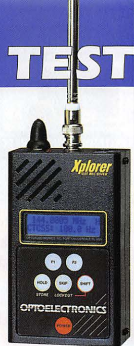
Capteur d'émissions FM proches. XPLORER 30 MHz à 2,6 GHz. Caractéristiques du signal
