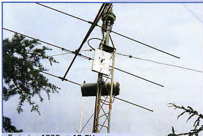
Emission 1255 et 10 GHz dans son enceinte thermostatée.
