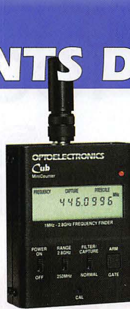
CUB Fréquence portable. 1 MHz à 2,8 GHz
