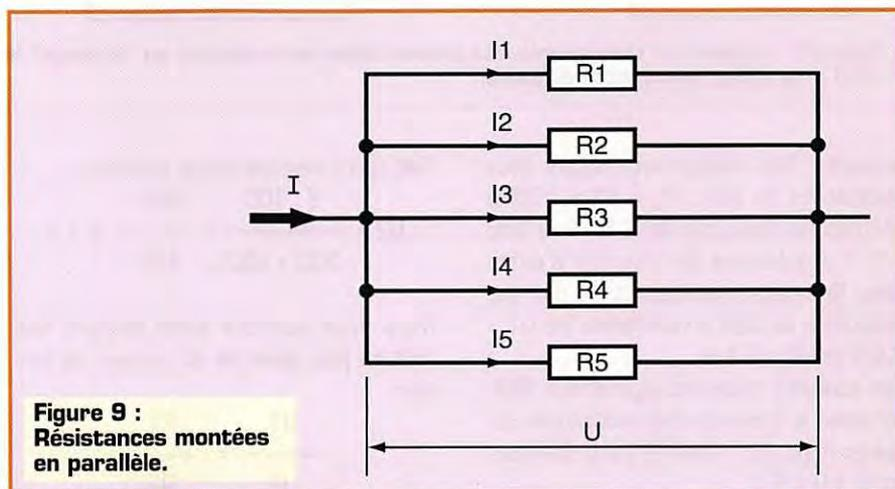
Figure 9 : Résistances montées en parallèle.
