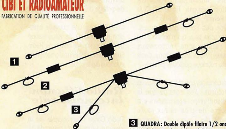
**1** DX-27: Dipôle filaire omnidirectionnel E/R, résonance 1/2 onde, puissance 500 W, balun étanche sur ferrite fermée, câble en acier inoxydable toronné, longueur 5,5 m, avec spires de réglage 27 à 32 MHz, isolateurs (5000 V) porcelaine, gain + 3,15 dBi, livrée prérégulée.
