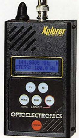
Capteur d'émissions FM proches. **XPLORER**
