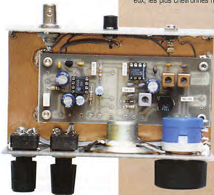
Platine dans petit boîtier en epoxy cuivré avec potentiomètres solidaires du boîtier. Pot2 est un multitours.
