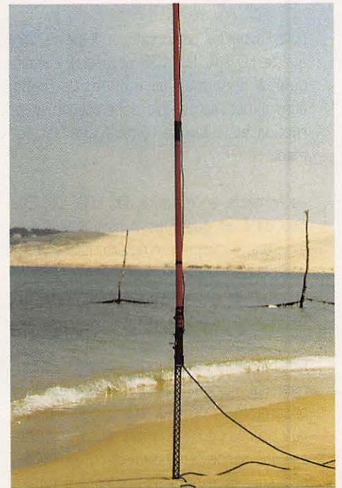
Vue rapprochée de l'antenne "canne à pêche, avec plan de sol idéal.
