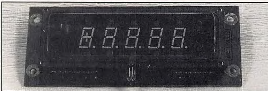
L'afficheur à décharge de gaz.
