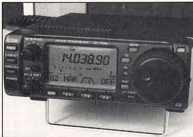
Le LCD affiche ici la position de l'IF-SHIFT.
