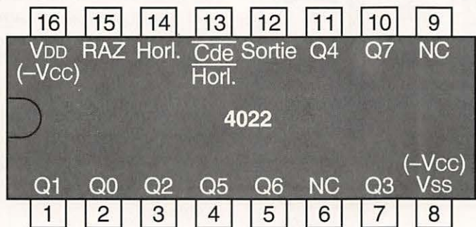
Figure 3a : Brochage du 4022 (vue de dessus !).
