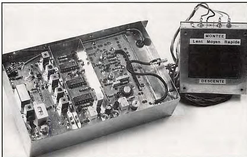
lons par cycle au minimum pour reconstituer le signal. L'horloge ci-dessus permet donc de synthétiser une fréquence comprise entre 5 Hz et 2,097 MHz, ce qui est tout à fait remarquable et impossible à obtenir avec un montage utilisant un seul circuit résonnant dans un oscillateur !
