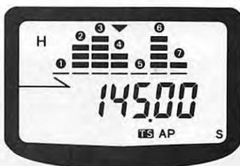
L'espacement est fonction du pas des canaux. Le tableau illustre un exemple avec pas de 25 kHz et fréquence centrale de 145,000 MHz.
