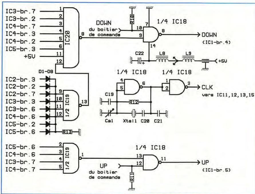
Fig. 3 - Logique de contrôle et horloge de 5,24288 MHz.
