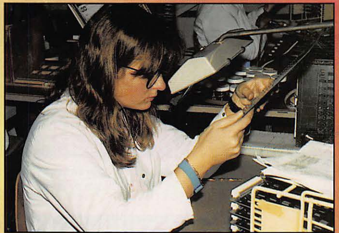
Le bracelet bleu de cette demoiselle n'est pas une marque de coquetterie : il évacue les charges statiques.
