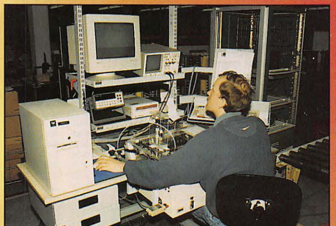
Banc de test fonctionnel pour électronique de plaques de cuisson « vitro céramique »..
