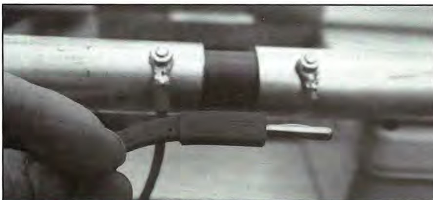
1 La liaison driver est effectuée avec une fiche banane mâle courante. Bien pour l'oxydation et les liaisons HF. Munissez vous de graisse HF.
