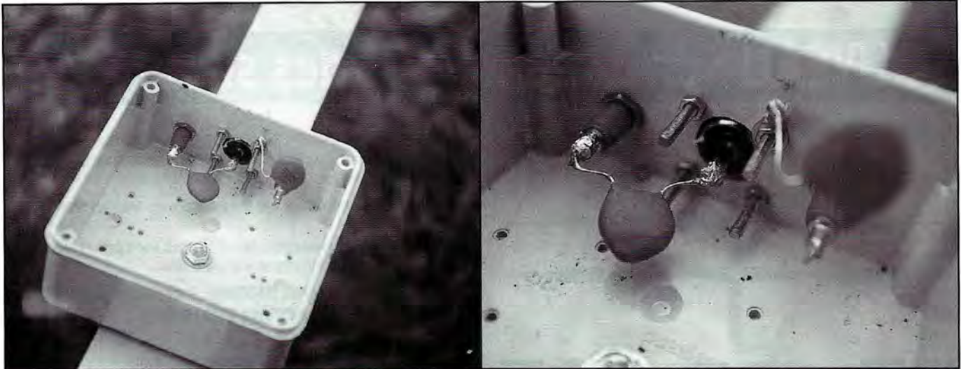
8 et 9 L'intérieur de la boîte. Voyez les soudures.
