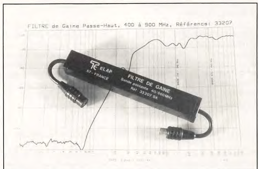
Filtre de gaine et passe-haut et sa courbe de réponse.
