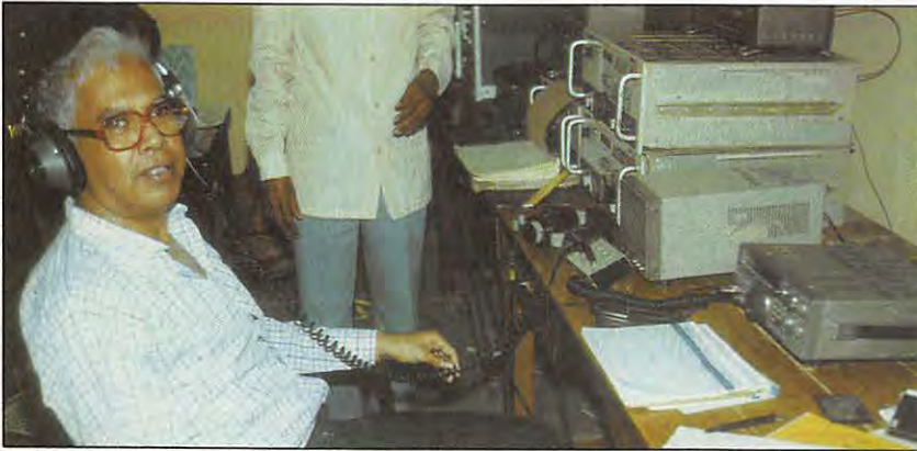
Un agent de la NBA écoute le trafic. On remarquera la boîte de raccordement multi casques pour le monitoring et les trois logs exigés pour les trois fréquences autorisées en SSB.
