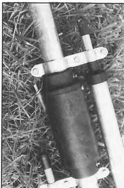
Montage des condensateurs.
