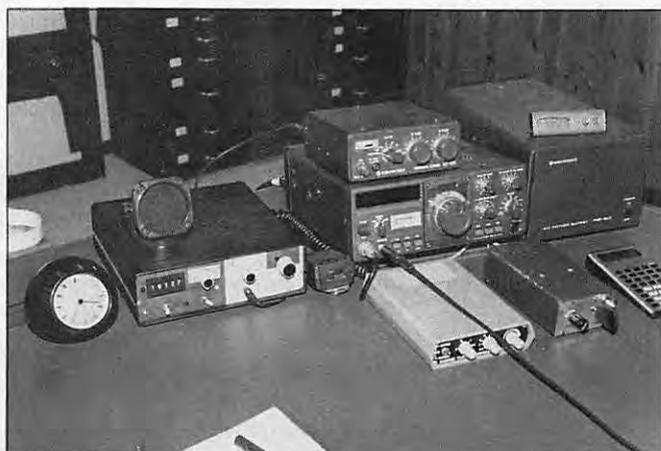
*A gauche, le transceiver 10 MHz - 2 W, est un compagnon agréable pour la station 100 W, TS120S. En fonctionnement, il ne fait pas figure de parent pauvre.*
