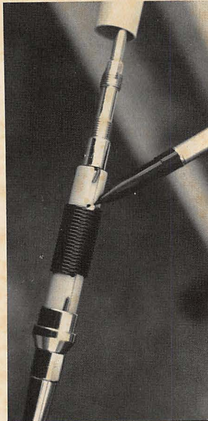
Photo 2 : Emplacement de la soudure sur la self.
