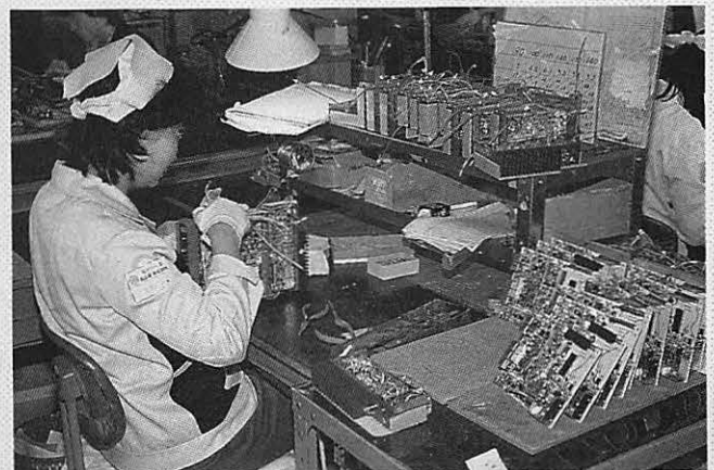
Insertion des sous-ensembles dans les boîtiers.
