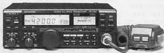
Emetteur-récepteur TR 751 E 144 à 146 MHz / tous modes / 25 W et 5 W HF / commutable en tous modes.
