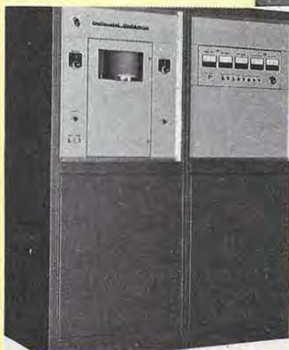
Emetteur ondes courtes 500 kW AM de Continental Electronics. La chaîne d'amplification comporte un étage transistorisé à large bande nécessitant 1 V efficace en entrée, un étage driver constitué d'une triode 3CW20, et un ampli de puissance utilisant une tétrode 4CM400000.
