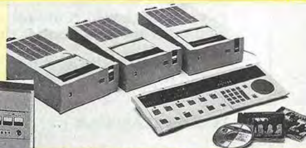
Système automatique de lecture de disques compacts pour stations de radiodiffusion (Philips).
