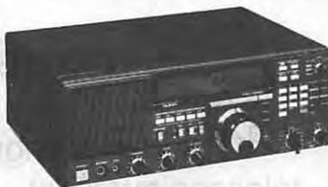
**YAESU - FRG 8800.** Récepteur à couverture générale de 150 kHz à 30 MHz. Tous modes. Interface de télécommande par ordinateur. Convertisseur VHF 118 à 174 MHz en option.
