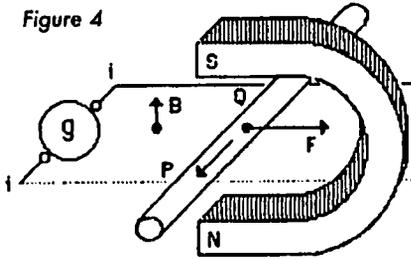
cadran à zéro central et l'aiguille se déplace dans un sens ou dans l'autre suivant le sens de passage de  $i$ . Le conducteur PQ étant immobile, on constate que  $i=0$ . Mais déplaçons le conducteur PQ, par exemple, vers la droite. On constate plusieurs effets :
