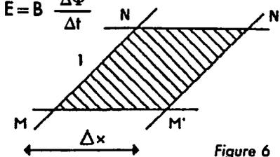
Dans cette démonstration,  $\Delta S$  est la surface balayée par le conducteur dans son déplacement,  $\Delta \Phi$  est le "flux coupé",  $\Delta \Phi / \Delta t$  est la vitesse de variation du flux. D'où la deuxième forme de la loi : la f.e.m. induite a pour valeur arithmétique la vitesse de variation du flux.
