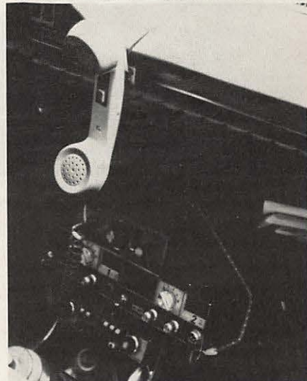
Matériel radio 85 et 160 MHz du véhicule PC de la Croix-Rouge.
