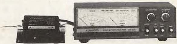
SW 200 Un wattmètre/Tos-mètre très précis, de 1,8 MHz à 450 MHz, permettant de contrôler simultanément 3 émetteurs et leurs antennes (voir schéma ci-dessous).
