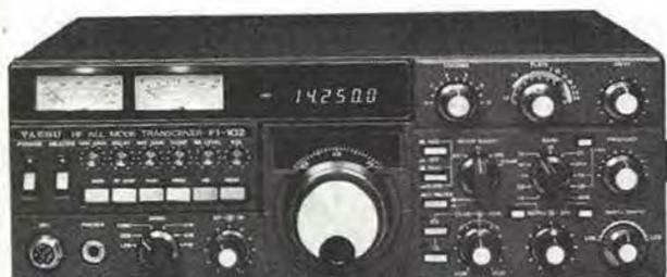
**FT 102** Transceiver décimétrique et nouvelles bandes WARC. SSB/CW/AM/FM. 3 x 6146B. DYNAMIQUE D'ENTREE: 104 dB.
