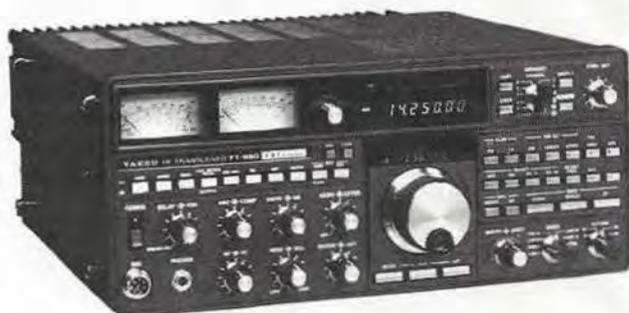
**FT 980** Récepteur 150 kHz à 30 MHz. Emetteur bandes amateurs. Tous modes AM/FM/BLU/CW/FSK, 120 W HF, tout transistor, alimentation secteur.
