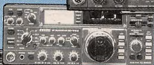
IC-740 Émetteur/Récepteur 100 W HF. FM/SSB/CW/RTTY. 2 VFO, mémoires, 3 vitesses, 2 filtres de bande variables, duplex. 9 bandes réception, 7 bandes émission. Vox-compresseur. Alim. 12 V, secteur incorporable. Nombreux accessoires disponibles.
