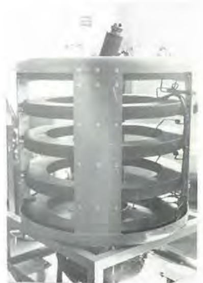
Le Klystron est glissé à l'intérieur d'un ensemble comprenant, sur la gauche, le réglage des cavités.
