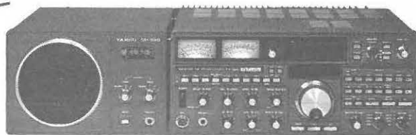
FT 980 - Emetteur bandes amateurs, récepteur toutes bandes. Entrée ordinateur.
