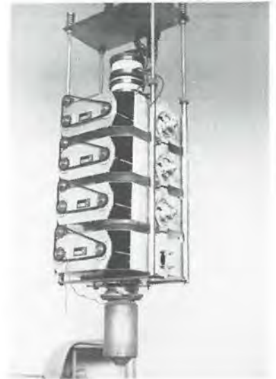
Le Klystron est glissé à l'intérieur d'un ensemble comprenant, sur la gauche, le réglage des cavités.
