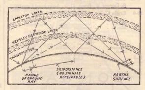
DIAGRAM SHOWING THE ETHERIC LAYERS WHICH REFLECT WIRELESS WAVES.
