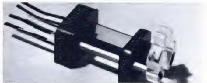
Bild 2. Wandlersystem des Tonabnehmers T 260
