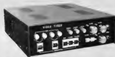
Der Datengenerator der japanischen Firma For-A, mit dem die Darstellung von Monat, Tag und Zeit auf dem Bildschirm eines Fernsehmonitors möglich ist
