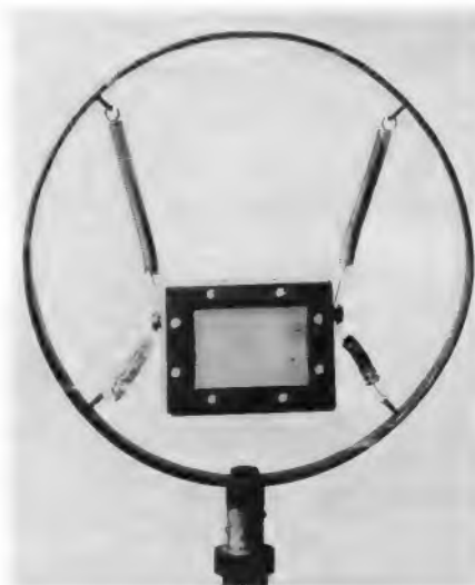
Ein vom Verfasser gebautes Marmorblock-Mikrofon, mit dem schon recht ordentliche Musikaufnahmen gelangen
