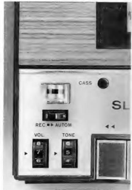
Bild 8. Aufnahme- und Wiedergabeeinsteller des Gerätes. Der waagerechte Knopf in der Mitte steht zur Zeit auf Automatik, beim Drehen nach links ergibt sich sogleich der Höchstwert für Handaussteuerung (Ziffer 10); links unten der Lautstärkeeinsteller und rechts unten die Tonblende für Wiedergabe, oben das Zeigerinstrument für Aussteuerungskontrolle und Batteriespannungsanzeige (Aufnahme: Limann)
