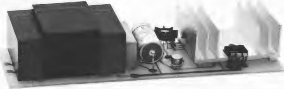
Stabilisiertes Netzgerät, Anschlußwerte: 220 V/50 Hz, -5 V, 2,0 A. Restbrumm bei Vollast: ca. 5 mV, kurzschlußfest durch integrierten Spannungsregler, vergossener Spezialtraho in extrem flacher Bauweise.
