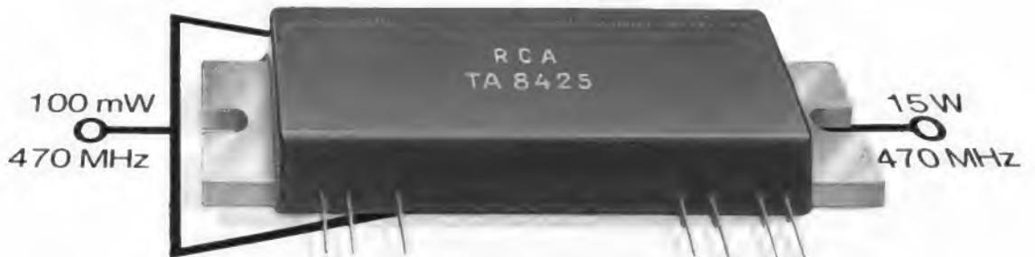
Zum Beispiel 470 MHz mit 15 W Ausgangsleistung
