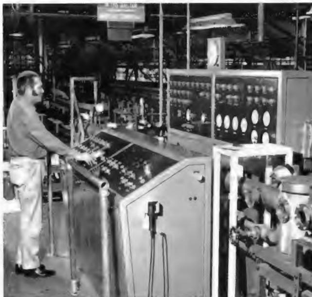
Bild 7. Prüfstand in der Kabelfabrik. Hier wird der Alu-Mantel – der äußere Leiter des Koaxialkabels – mit der endgültigen Isolationschicht versehen
