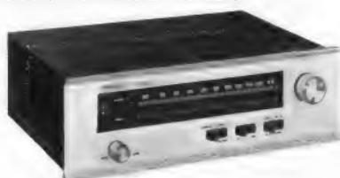
Volltransistorisierter UKW-Stereo Tuner mit einer Eingangsempfindlichkeit von 1,3 µV und einer Kanaltrennung von 40 dB/1000 Hz. Ausgestattet mit Muting, Stereofilter und Feldstärkenanzeige. Die harmonische Verzerrung über den hörbaren Frequenzbereich ist kleiner als 0,05%
