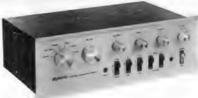
Transistorisierter Stereoververstärker mit umfangreichem Kontrollpanel. Verzerrungen über den gesamten Frequenzbereich in beiden Kanälen nicht meßbar. Für Anschluß von sowohl Transistor- als auch Röhrenendstufen. Frequenzbereich bei Hochimpedanzeingang 10–100.000 Hz  $\pm$  0,5 dB, bei Niederimpedanzeingang 20–20.000 Hz  $\pm$  1 dB, Kopfhöreranschluß 800 Ohm.
