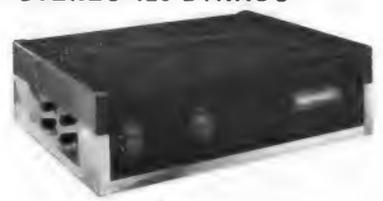
Eine kompakte Endstufe mit einer Ausgangsleistung von 2 X 60 Watt sinus. Betriebssicher auch bei hohen Dauerbelastungen wie Discotheken etc. Harmonische Verzerrungen kleiner als 0,5% bei voller Ausgangsleistung über alle Frequenzen von 5–50.000 Hz. Kanaltrennung besser als 70 dB von 20–20.000 Hz. Volltransistorisiert.
