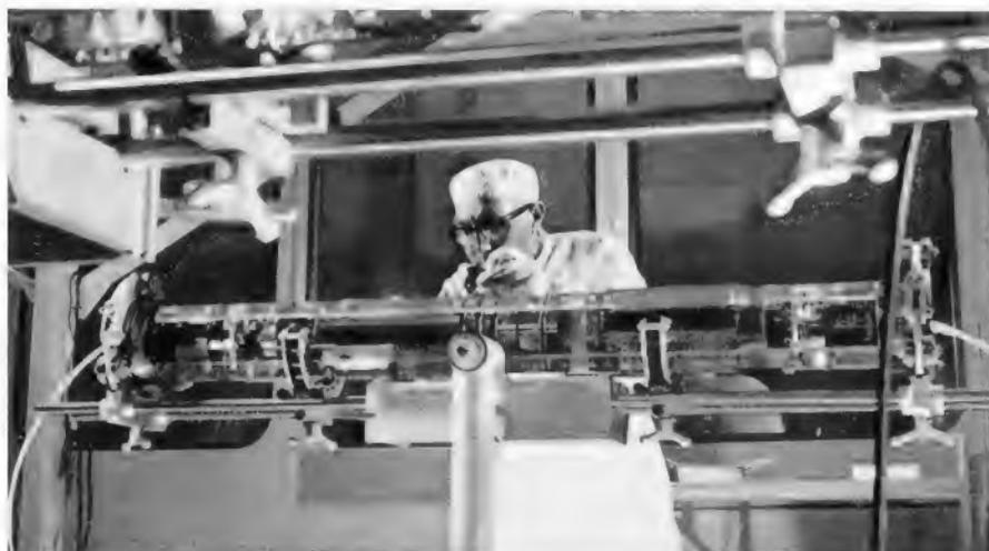
Bild 3. Letzte Hand an dem fast fertigen Unterwasserverstärker. Man erkennt die scheibenförmigen Sektionen mit den bulk heads an beiden Enden
