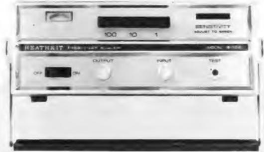
Erweitert den Anzeigebereich des nebenstehenden Frequenzmessers IB-101 und den anderer handelsüblicher Zähler mit 1 Hz- und 1 kHz-Taktgebern bis 175 MHz · Modernste Halbleiterschaltung mit TTL- und ECL-ICs · Niedrige Ausgangsimpedanz · Stufenlos regelbare Eingangsempfindlichkeit · Max. Eingangsspannung 3 Veff · Triggerpegel-Schnelleinstellung mit Anzeigeeinstellung und Prüfschalter · Dekaden-Druck-tasten-Wahlschalter · Vollstabilisiertes Netzteil.
