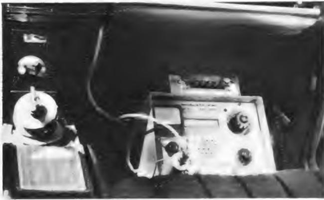
◀ Bild 10. Mit dem links oben eingebauten Hf-Schalter kann wahlweise die Stab- oder die Scheibenantenne an das Plisch-Störmeßgerät angeschlossen werden, so daß während der Fahrt die dB-Zahlen schnell zu ermitteln sind
