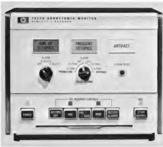
Bild 8. Arrhythmie-monitor (Hewlett Packard), mit den mittleren Drucklasten wird die gewünschte Betriebsart eingestellt. Die Alarmgrenzen werden mit den oberen Bedienungsknöpfen eingestellt
