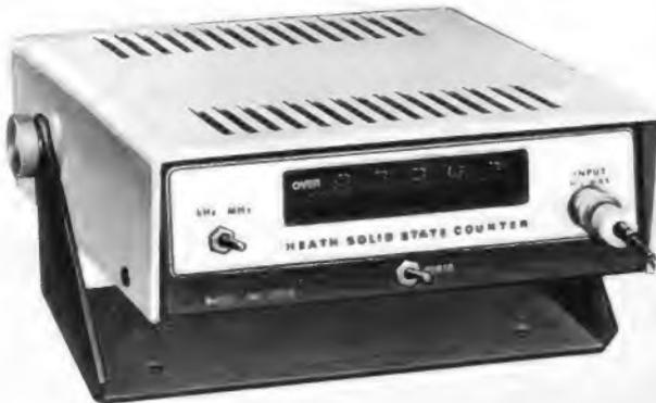
Meßbereich 10 Hz bis über 80 MHz · Hochstabile, betriebssichere Schaltung mit ultraschnellen Schottky-Dioden · 5-stellige Leuchtdioden-Anzeige · OVERRANGE-Blinkschaltung mit Leuchtdiode · 8-stellige Speicherkapazität · MHz/kHz-Umschalter · Quarzstabiler 1 MHz-Mutteroszillator, gegen Aufpreis auch mit thermischer Stabilisierung (Quarzolen) lieferbar.
