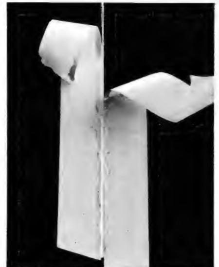
Bild 1. Ein Leitsilberfaden läßt sich mit Hilfe von zwei in kleinem Abstand parallelaufgeklebten farbigem Tesafilmstreifen herstellen, die sich nach dem Auftragen und Trocknen des Leitlacks leicht abziehen lassen. Der Silberfaden bleibt auf der Windschutzscheibe zurück
