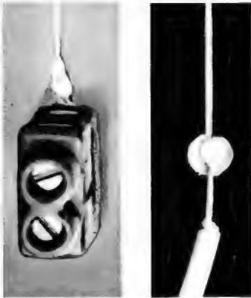
▲ Bild 2. Der Silberfaden kann durch einen Leit-silberstrich mit dem Metall einer auf die Windschutzscheibe geklebten Elastikklemme leitend verbunden werden
