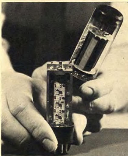
Ein moderner Hybrid-Breitbandverstärker für 10 MHz bis 1 GHz im Größenvergleich zu einer früheren Endröhre (Rohde & Schwarz)
