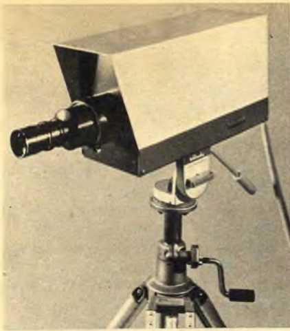
◀ Bild 7. Farbfernsehkamera FAC 60 von Grundig mit drei 1-Zoll-Vidicon-Aufnahmeröhren
