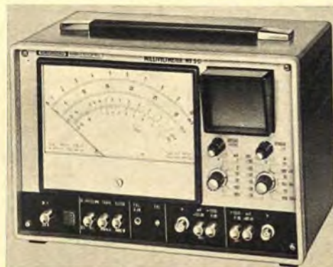
▲ Bild 1. Millivoltmeter mit eingebautem Elektronenstrahl-Oszillografen zum Untersuchen der Kurvenformen der Meßspannungen (Grundig)
