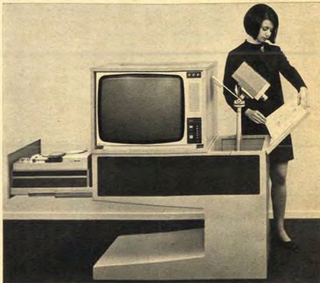
Bild 1. Kombination aus Fernsehempfänger, Videorecorder, Kleinkamera und Mikrofon von Philips, genannt „Fernseh-Tutor“, bestimmt für Unterrichts- und Demonstrationszwecke
