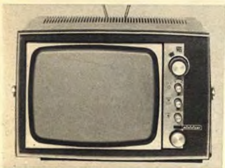
Bild 3. Minivisor TA 675, ein 28-cm-Portable von Videoton (Ungarn), das noch weitgehend mit Röhren bestückt ist
