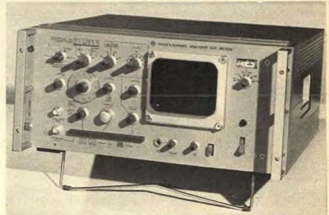
Bild 12. Analyskop EZF zum Untersuchen von Frequenzbändern (Rohde & Schwarz)
