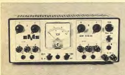
Bild 14. Stabilisiertes Netzgerät mit drei voneinander unabhängigen einstellbaren Ausgangsspannungen (EMS)
