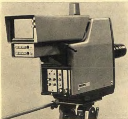
Bild 9. Farbfernseh-Kompaktkamera LDH 1 von Philips mit abnehmbarem 7-Zoll-Schwarzweiß-Monitor/Sucher, darunter Einschubverstärker und das herausnehmbare Bedienungsteil für Verstärkung, Weißbalance, Schwarzpegel und Blende
