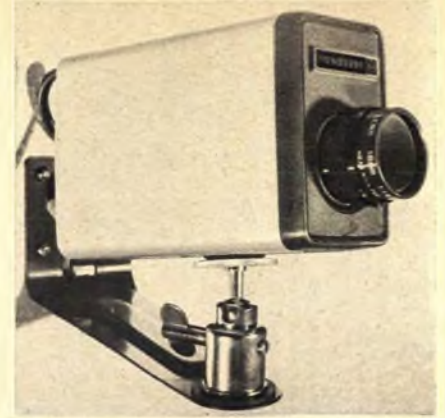
Bild 4. Sehr einfach aufgebaute Überwachungskamera von Matsushita. Die Schärfereinstellung erfolgt mit Hilfe des Objektivs (Aufnahme: Schwahn)
