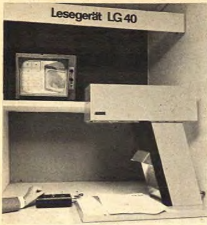
Bild 2. Fernseh-Lesegerät LG 40 mit ferngesteuerter schwenkbarer Kamera FA 42 S von Grundig
