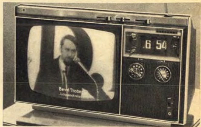
▲ Bild 2. Fernseh-Portable von Matsushita (National) mit eingebauter Digital-Schaltuhr
