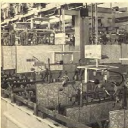
Bild 4 (zugleich Titelbild). Zuschnitte mit Siebdruckfarbe vor Beginn der galvanischen Aufkupferung
