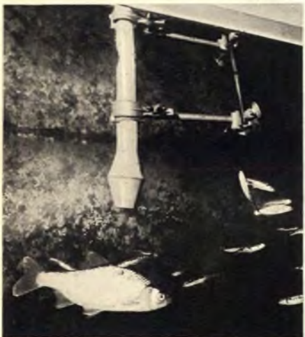
Bild 1. Fische werden mit einem wasserdicht abgeschlossenen dynamischen Mikrofon belauscht
