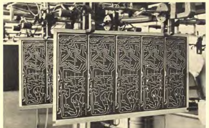
Bild 5. Fertig bearbeiteter Zuschnitt nach der chemisch-galvanischen Behandlung: Basisschicht abgeätzt, Leiterbahn mit Pb-Sn-Auflage
