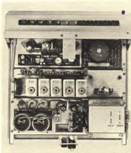
1-W-Sender mit 20 Suchmöglichkeiten
