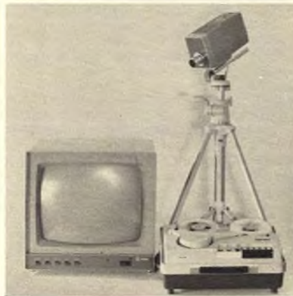
Fernschaufzeichnungs- und Wiedergabeanlage von Philips, bestehend aus Video-Recorder, Fernsehkamera und Empfänger
