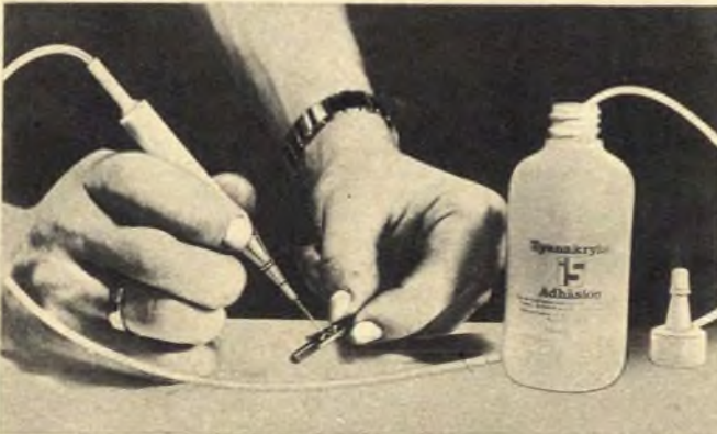
Bild 2. Halbautomatisches Auftragen des Klebers mit einer Auftragsnadel (Werkaufnahmen: Loctite-Technik Deutschland, Frankfurt/M.)
