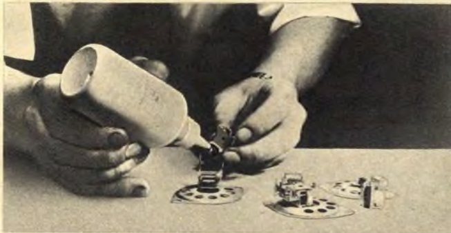
Bild 1. Verkleben von Lautsprecherteilen mit dem schnell härtenden Klebstoff IS-12
