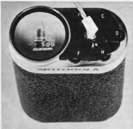
Im Rahmen eines speziellen Subminiatur-Projektes entwickelte Motorola diesen weniger als 500\text{ g} wiegenden Kleinstempfänger
