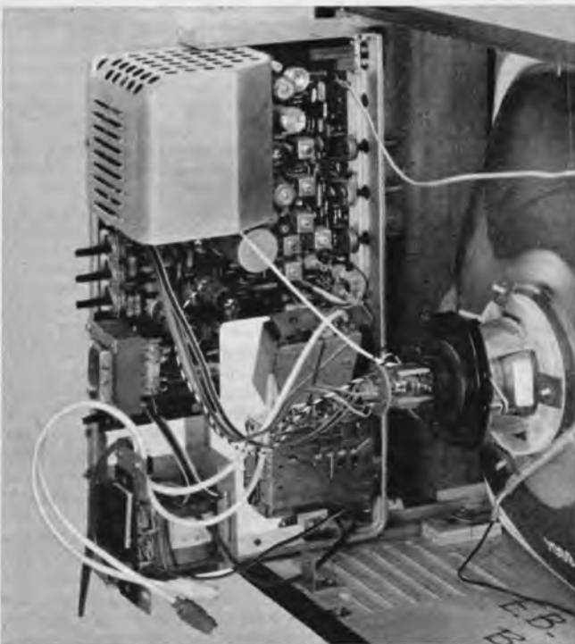
Bild 8. Herausgezogenes Chassis des Schwarzweißempfängers der französischen Firma Continental Edison
