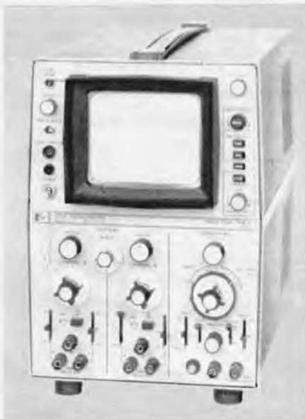
Bild 5. Zweistrahloszillograf, Typ 1201 A, von Hewlett-Packard
