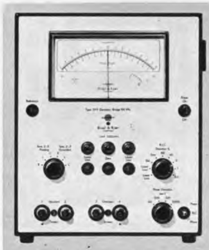
Bild 9. RLC-Toleranzmeßbrücke von Brüel & Kjaer
