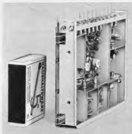
Bild 4. Der neue Elektronik-Diodentuner von Imperial General Electric ist auf einer einzigen Leiterplatte aufgebaut. Er wird in das Chassis eingesetzt und tauchverlötet
