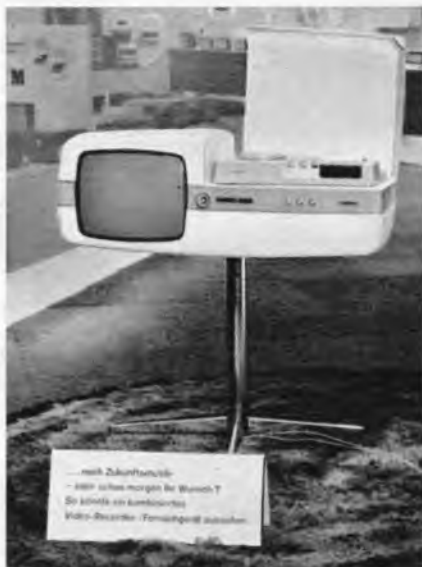
Versuchsausführung einer Kombination von Videorecorder LDL 1000 mit kleinem Schwarzweiß-Fernsehempfänger (Philips)
