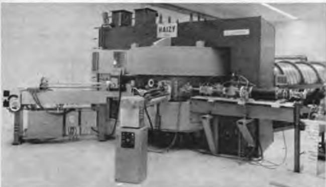
Das Hamburger Isochronenzyklotron (HAIZY) ähnelt in seinen Hauptkonturen einem großen Transformator. Die Maschine wird von einer Schaltwarte aus ferngesteuert, da der mit Beton abgeschirmte Maschinenraum während des Betriebes unter Strahlung steht und nicht betreten werden kann. Nach rechts geht die Rohrleitung ab, die den Strahl in die Experimentierhalle leitet
