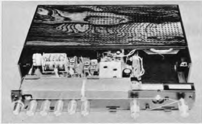
Bild 5. Reiseempfänger RP 235 von Imperial General Electric mit leicht herausnehmbarem Chassis
