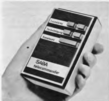
Bild 5. Fernbedienungsteil des Saba-Telecommanders
