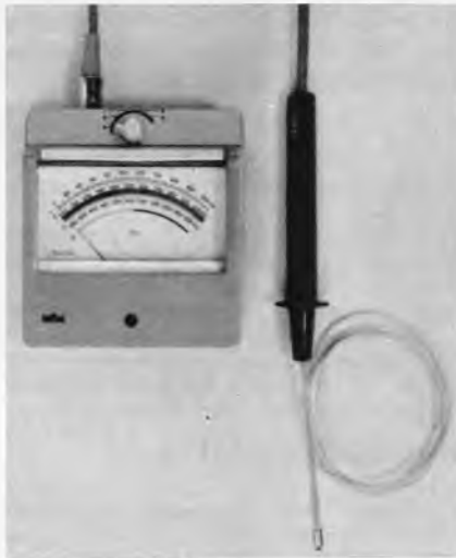
Bild 11. Temperaturmeßgerät Tasterm mit flexiblem Fühler von Braun
