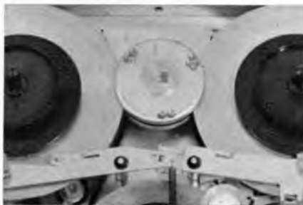
Bild 5. Wirbelstromkupplung für den Bandtellerantrieb
