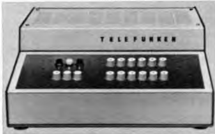
Bild 1. Zentrale, Typ D 701, der drahtlosen Personenrufanlage von AEG-Telefunken zum Anrufen von bis zu 30 Teilnehmern
