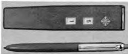
Bild 2. Der Rufempfänger, Typ D 761, besitzt auswechselbare Selektiv-Bausteine, was das Wechseln der Rufnummer ermöglicht
