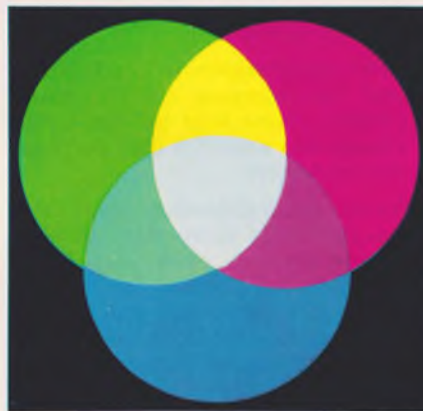
Oben: Bild 2. Additive Farblightmischung. Die Farbschichten der Primärfarben und die Mischfarben wurden mit Farbfarnleuchtstoffen hergestellt. Anregung der Leuchtstoffe durch UV-Licht
