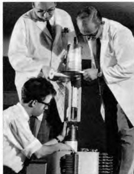
Links: Maschinen zum Ätzen der Aluminiumfolien für Elektrolytkondensatoren
