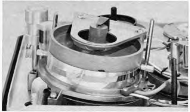
Bild 6. Schräggestehende Trommel mit den darin rotierenden zwei Videoköpfen. An der linken Trommelunterseite befindet sich eine Wirbelstrombremse, die auf eine Aluminium-Scheibe einwirkt
