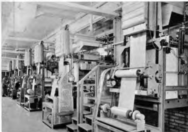
Links: Maschinen zum Ätzen der Aluminiumfolien für Elektrolytkondensatoren
