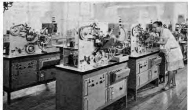
Vollautomatische Wickelplätze für Styroflexkondensatoren im Wernerwerk für Bauelemente der Siemens AG
