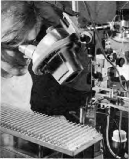
Das Kontaktieren integrierter Schaltungen unter dem Stereo-Mikroskop
