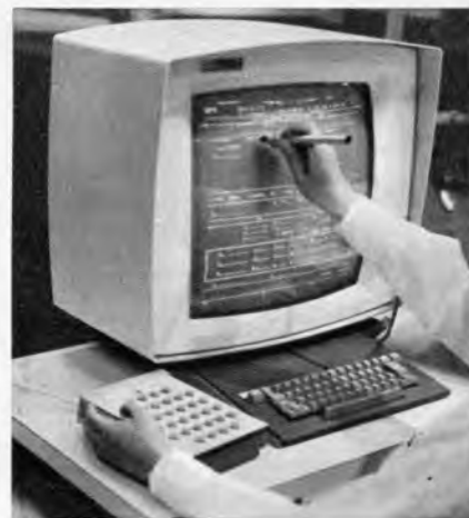
Bild 4. Mit dem Lichtstift zeichnet ein Produktionsleiter im projizierten Terminplan eine Linie, die den Arbeitsbeginn und das Arbeitsende eines Tonmeisters in der betreffenden Produktion markiert. Diese Angaben werden außerdem über die Tastatur in binäre Zahlenwerte verwandelt und dem IBM-System 360 Modell 50 eingegeben
