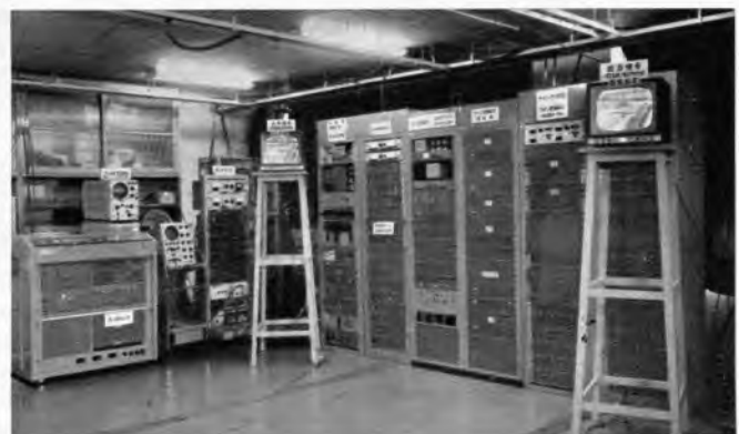
Rechts: Bild 1. Versuchsmodell eines Fernseh-Normwandlers (625 Zeilen/50 Raster auf 525 Zeilen/60 Raster und umgekehrt)
