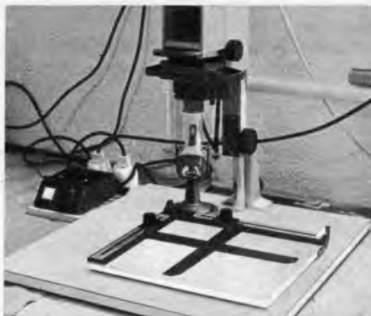
Oben: Bild 2. Der Belichtungsautomat ist in dem schwarzen Gehäuse (links) untergebracht. In der Mitte des Bildes die als Reflektor für den Fotowiderstand umgebaute Taschenlampe
