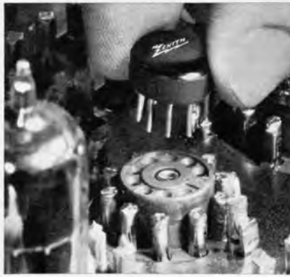
Bild 1. Großaufnahme von einem Teil des Farbfernsehchassis von Zenith mit dem Farbartdemodulator in IS-Technik
