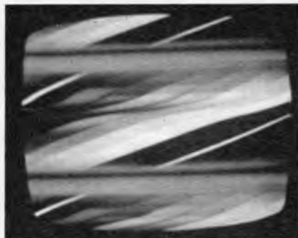
Bild 2. Farbe synchronisiert nicht; der Versorgungsspannung ist eine Brummspannung überlagert (rechts). Ursache: Lade- und Siebkondensatoren im Stromversorgungsteil haben keine Kapazität
