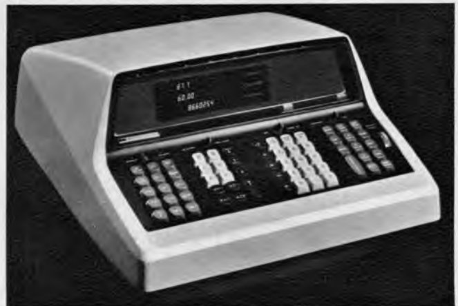
Bild 2. Der Tischrechner 9100 A, für technisch-wissenschaftliche Berechnungsgänge gedacht, eines der aufsehenerregenden Exponate der Interkama, verzichtet interessanterweise auf die Verwendung integrierter Schaltungen (Hewlett-Packard)
