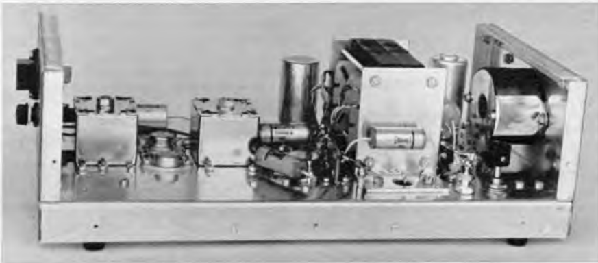
Bild 5. Obere Aufbauten des Chassis ohne Haube. Bauelemente von links nach rechts: Tr 1, T 5, T 6, Tr 2, T 7, T 8 (dahinter C 8), Tr 3, vorn eine der Dioden D 13...D 16, vorn Schalterknopf, dahinter T 11, darüber Dr
