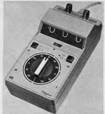
Bild 4. Trotz dreistelliger Digitalanzeige kaum größer als das klassische Multivolt: das Digavi. Der vordere Teil mit dem Meßbereichumschalter lößt sich zur Umstellung des Instruments auswechseln (Hartmann & Braun)
