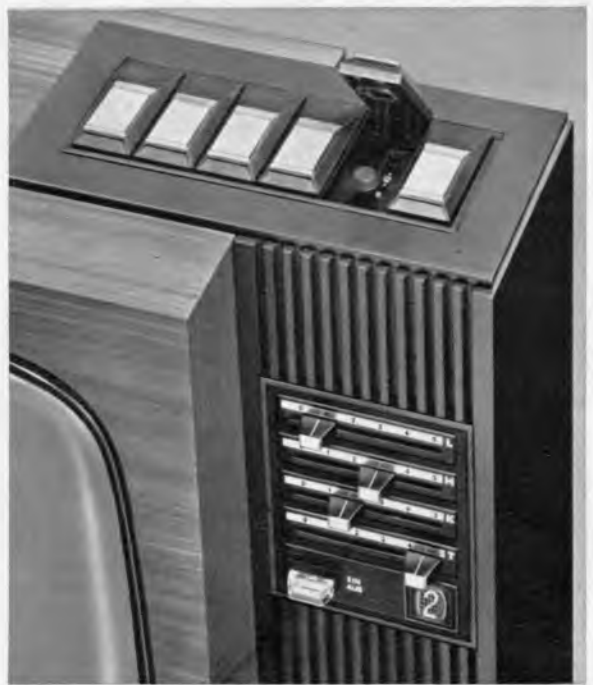
Bild 3. Tastatur und Schieberegler am Prestige CC. Rechts unten die Ziffernanzeigeröhre ZM 1182 hinter Filterglas
