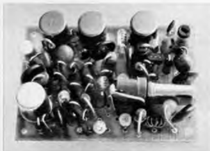
Bild 3. Aufbau des Empfängers. Oben sind die drei keramischen Filter zu erkennen. Links davon befindet sich die integrierte Schaltung. Der Quarz ist steckbar
