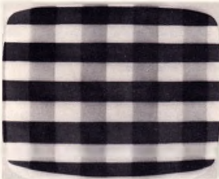
Bild 1. Graustufenmuster des Farbbildgebers 957 A mit vier verschiedenen Grauwerten
