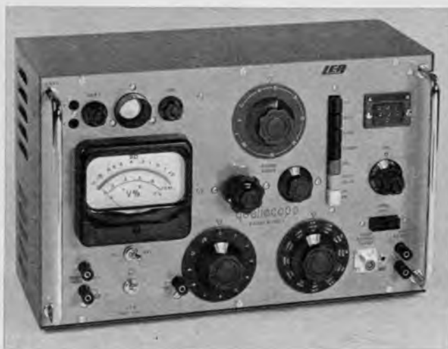
Links: Bild 5. Klirrfaktormesser, Pegelmesser und Millivoltmeter wurden im „Qualiskop“ geschickt kombiniert (LEA)
