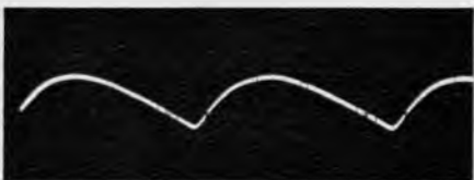
Bild 4c. Brummspannung am Siebkondensator C 3 5 V ss
