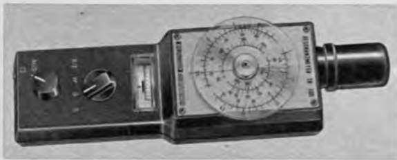
Bild 3. Das Resonanzmeter TR 300 (Dipmeter) arbeitet mit Feldeffekt-Transistoren (Grundig)
