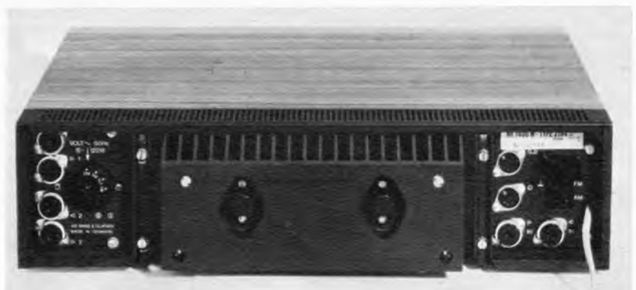
Bild 2. Rückansicht des Empfängers. Links die Buchsen für die Lautsprechergruppen, in der Mitte Kühlkörper mit den beiden Leistungstransistoren 2 N 5034, rechts die Antennenbuchsen und die Eingänge
