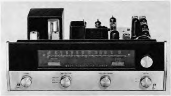
Bild 7. Die Frontplatte des McIntosh-Tuners MR 71. Man erkennt die diversen Abstimmkontrollen. Selbst die Röhren tragen den McIntosh-Stempel
