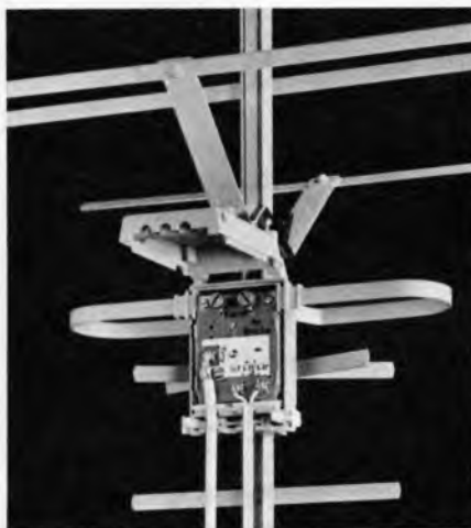
Bild 2. Antennen-Anschlußgehäuse mit eingesetzter Einbauweiche
