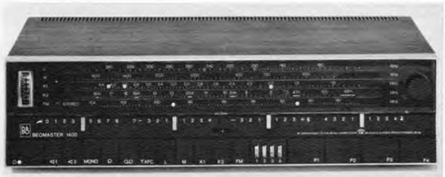
Bild 1. Frontansicht des Beomaster 1400 M. Die Frontseite ist dreigeteilt. Oben: Skala mit Abstimmindikator. Mitte: Schiebepotentiometer für Lautstärke, Tiefen, Höhen und Balance sowie die KW-Lupe. Unten: Tasten für die Bedienung und vier Einsteller für vier UKW-Stationstasten
