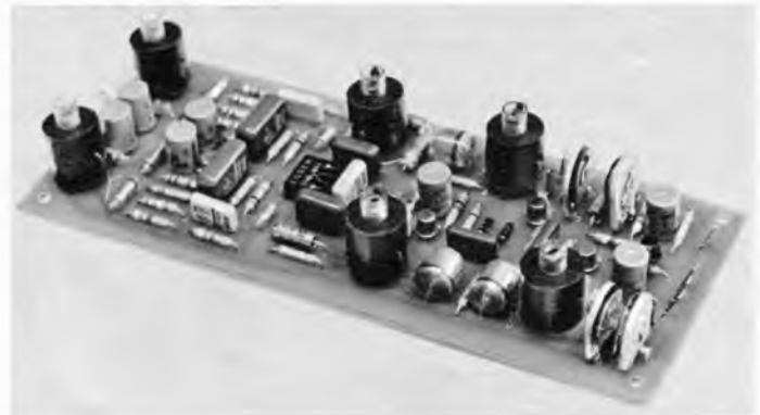
Bild 9. Seitenansicht des Decoders. Die Spulenkörper sind mit den Halterungen in die Platine eingeklebt
