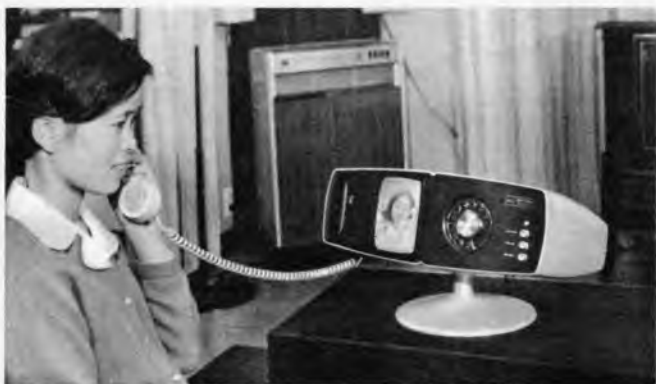
Fernseh-Telefon von Toshiba mit einem 315-Zeilen-Bild und der üblichen Wählscheibe für Fernsprechen ohne Bild
