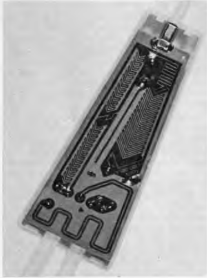
Bild 8. Trenn- oder Empfängerweiche (für Fernsehen) in gedruckter Schaltung mit Empfängeranschlußsnur. Eingang 60 Ω - Ausgang 240 Ω
