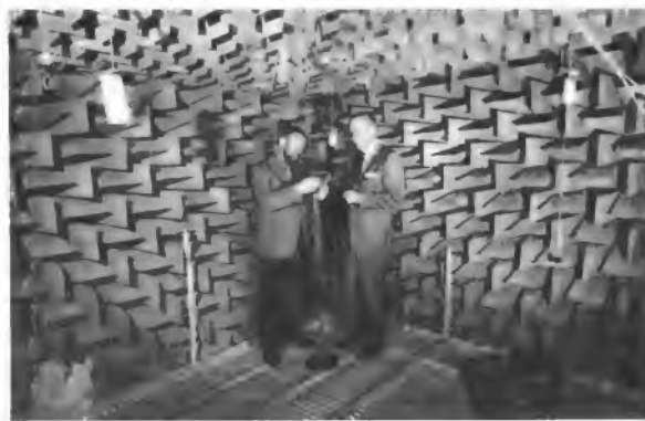
Die Wände des schalltoten Raumes von Bang & Olufsen sind mit etwa 2000 Steinwollkeilen bekleidet. Dieser Raum dient zum Prüfen von Mikrofonen und Lautsprechern
