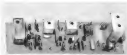
Bild 1. Beispiel für eine Baugruppe, die STC nunmehr in England für Amateure anbietet: transistorbestückter Zf-Verstärker mit Verstärkungsregelung und Telegrafieüberlagerer. Lieferbar für Z_f = 455 kHz und Z_f = 1620 kHz
