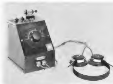
Detektorempfänger mit Kopfhörer aus dem Jahre 1925 von Telefunken. Der Einkreis-Empfänger arbeitet mit Variometerabstimmung im Wellenbereich 200...700 m, mit Zusatz 700...2250 m. Das Gerät kostete damals 21 RM, der steckbare Detektor (oben) 4 RM und der Kopfhörer 14 RM (Telefunken-Archiv)
