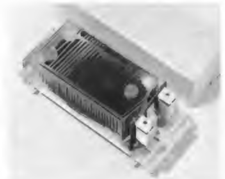
Bild 1. 64-µsec-Verzögerungsleitung in Quaderform für Pal-Farbfernsehempfänger (Valvo)
