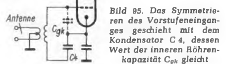
Bild 95. Das Symmetrieren des Vorstufeneinganges geschieht mit dem Kondensator C 4, dessen Wert der inneren Röhrenkapazität C_{pk} gleicht
