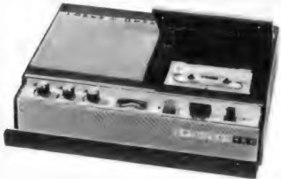
Bild 2. Das Optacord 450 besitzt eine Bandgeschwindigkeit von 4,75 cm/sec und verwendet die Compact-Cassette. Das Gerät enthält insgesamt zehn Transistoren und fünf Dioden
