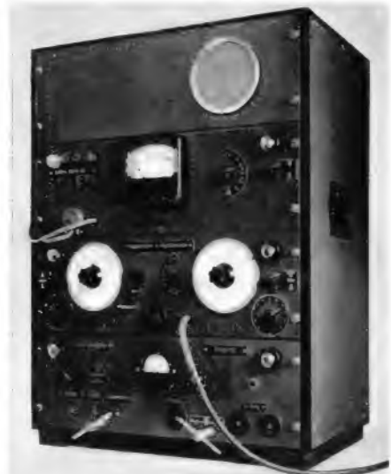
Bild 3. Meßplatz M 4912 in Gestellbauweise von 1949, gebaut im damaligen Labor Limann
