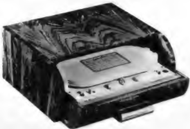
Bild 1. Das erste Kassettentonbandgerät von Loewe Opta aus dem Jahre 1951 hatte eine Bandgeschwindigkeit von 19 cm/sec. Die Aufzeichnungsdauer betrug 2 x 30 Minuten
