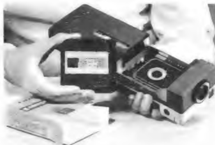
Bild 3. Die Super-8-Kassette läßt sich leicht einlegen. Die hier zur Demonstration verwendete Kamera ist ein Modell von Kodak
