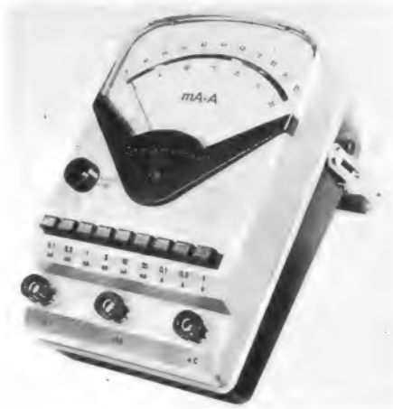
Polycontrole-Vielfachmeßgerät mit Drucktasten
