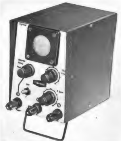
Miniatur-Oszillograf mit 3-cm-Röhre
