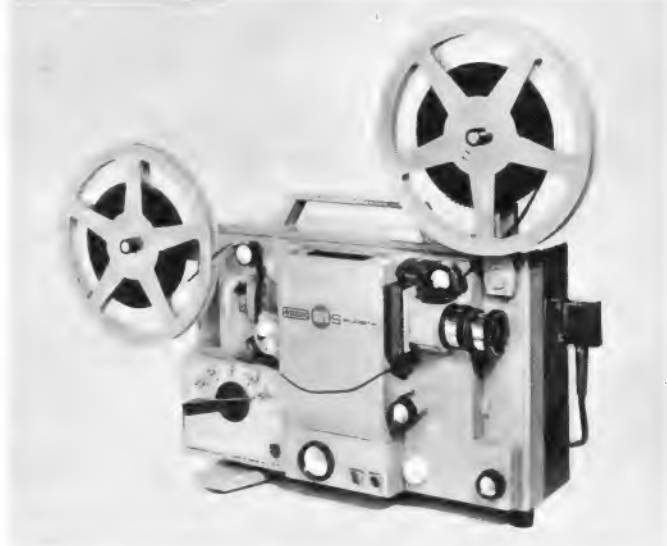
Bild 6. Der Magnettonprojektor Eumig-Mark-S-Super-8 mit Einfädelaufnahme für den Bildteil. In den Tonteil wird der Film wie in ein Tonbandgerät eingelegt, dann wird die Filmspule eingehängt. Ein Zentralschalter mit verriegelter Aufnahmetaste vereinfacht die Bedienung. Der Projektor ist mit einer Jod-Quarzlampe 12 V/100 W und einem Vario-Projektionsobjektiv 1:1,3/15...25 mm sowie einem Doppelzahngreifer ausgestattet
