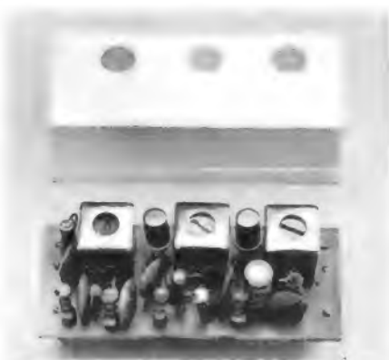
Bild 1. Ansicht des Zf-Moduls IF 5, das einen vollständigen AM/Zf-Verstärker darstellt. Die Abmessungen betragen nur 24 mm \times 57 mm (Werco)
