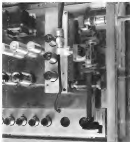
Bild 3. Empfangskonverter zum Umsetzen der 12-GHz-Frequenz in eine 70-MHz-Zwischenfrequenz
