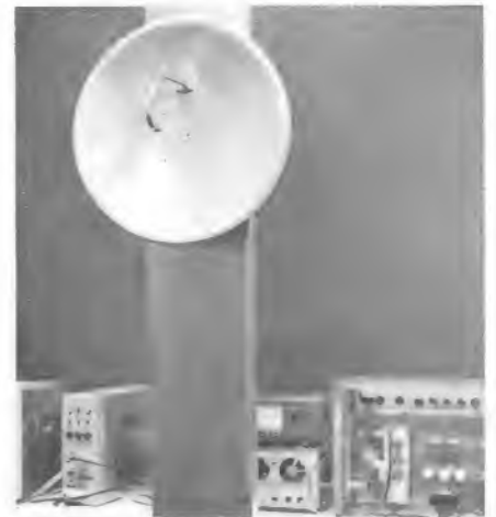
Bild 1. Parabolantenne für den 12-GHz-Bereich mit 65 cm Durchmesser, einem Strahlungswinkel von 2,8^\circ und einem Antennengewinn von 35 dB
