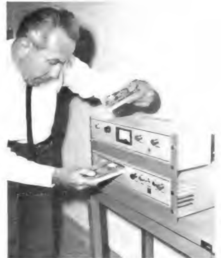
Bild 3. Tonbandkassettengerät als Informationsträger für den Verkehrswarnfunk
