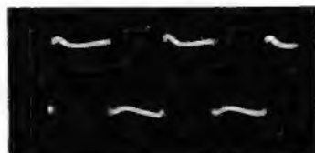
Bild 44. Höhen und Tiefen angehoben (Mitten abgesenkt)
