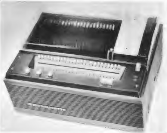
Radionette-Multiplayer ist der Name eines Phonogerätes, das mit 25 Platten bestückt werden kann. Sie drehen sich um eine waagerechte Achse und können von beiden Seiten abgetastet werden
