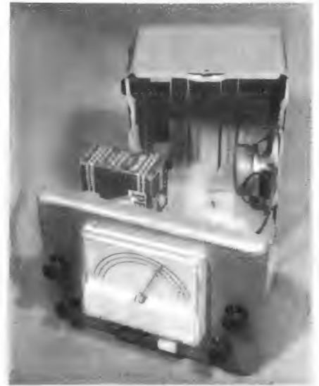
Bild 1. Frontansicht des Transistor-Zweikreisempfängers bei abgenommenem Gehäuse
