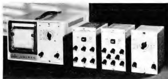
Tragbarer Universalschreiber Unireg von Siemens mit Mikroampereinschub. Daneben drei weitere Meßbereichseinschübe
