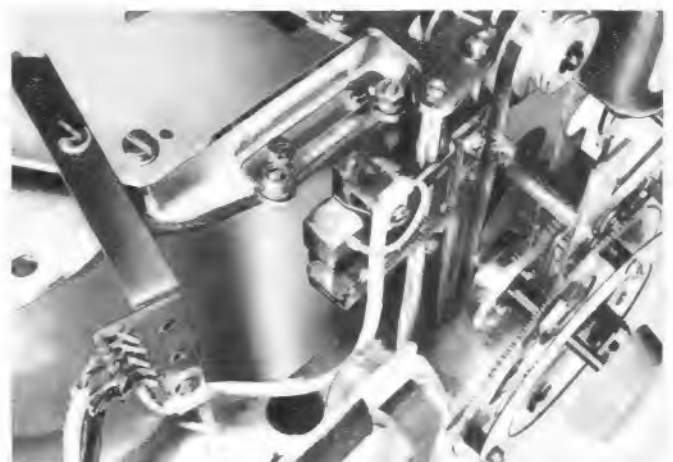
Bild 6. Mechanischer Steuerteil für die Kopfträgerplatte. Die Parallelführung zur Bandfläche erfolgt durch zwei zylindrische Metallstangen. Die Höhenverstellung wird durch ein Metallband vorgenommen
