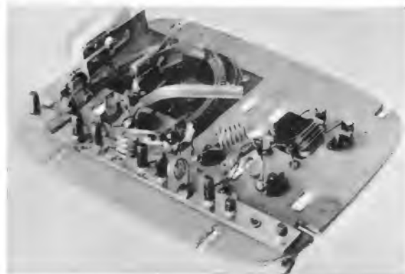
Bild 9. Kathrein-Antennenweiche mit zwei Variospulen links oben
