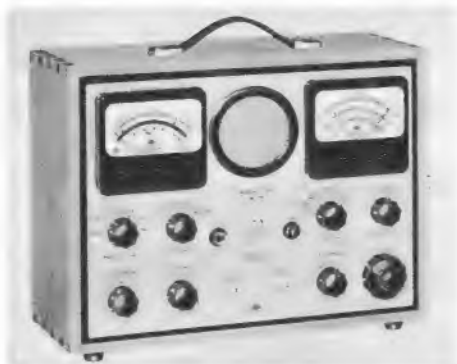
Bild 5. Das Überlagerungsvoltmeter Typ 2008 von Bruel & Kjaer mißt HF-Spannungen bis herab zu 2 \mu\text{V} . Spannung und Frequenz werden an Zeigerinstrumenten angezeigt
