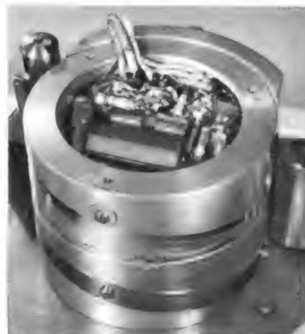
Bild 2. Blick in die Kopftrommel mit Verstärker und Umschaltrelais
