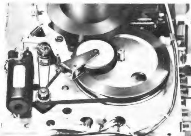
Bild 5. Der Bandablauf erfolgt durch Antreiben der Aufwickelspule. Da die Bandgeschwindigkeit nicht konstant sein muß, kann die Antriebsrolle direkt auf die Aufwickeltrommel wirken
