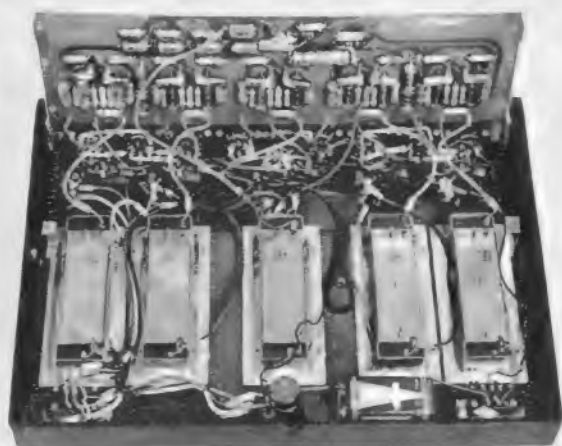
Bild 2. Das Gerät mit abgenommener Bodenplatte und herausgeschwenktem Verstärkerenteil
