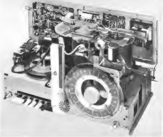
Rechts: Bild 4. Chassisansicht des Tonbandteiles. Vorn die große Anzeigeskala, hinten ist stehend die gedruckte Platine zu erkennen
