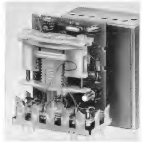
Bild 9. Das Demodulator- und Ratiofilter mit der letzten Zf-Stufe
