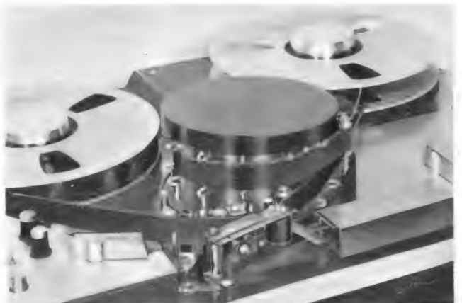
Bild 2. Blick auf den Bandantrieb und die Bildbandtrommel
