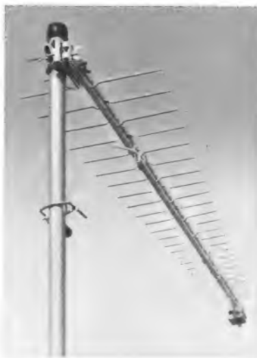
Bild 2. Dezi Durant 26 ist eine Fernsehantenne nach dem Prinzip der bisher nur professionell verwendeten logarithmisch-periodischen Antenne (Kathrein)
