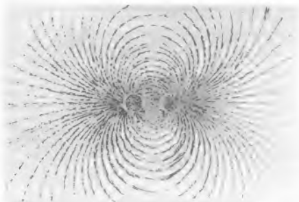
Bild 3. Magnetisches Induktionsfeld der 1-kHz-Spule
