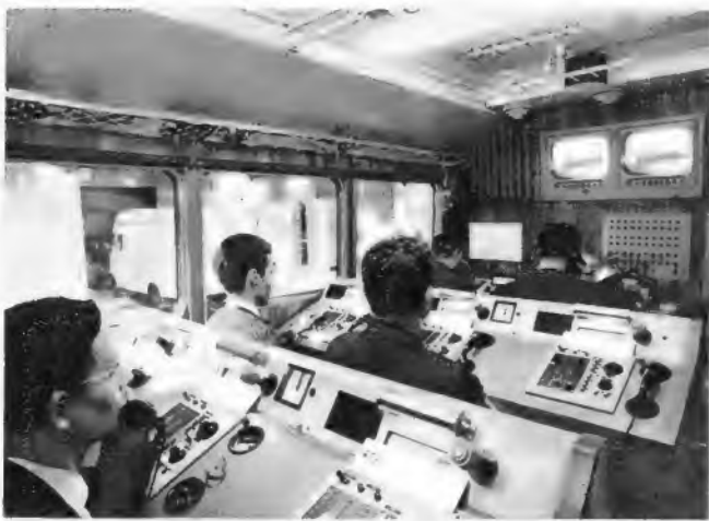
Bild 11. Blick in den Tonsteuerungsteil des Eurovisions-Wagens im Studio B. Hier waren zehn Überwachungsplätze eingerichtet und besetzt
