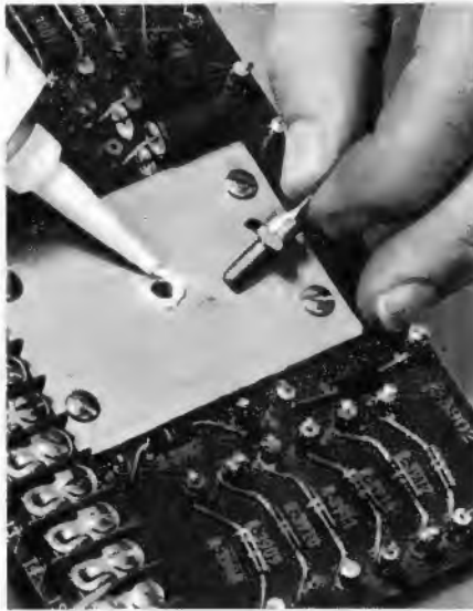
Die Silikonpaste leitet die Wärme dreimal schneller ab als die bisher üblichen Wärme-materialien
