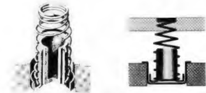
Bild 1. Die gedämpfte Federaufhängung des Plattenspielers Dual 1009
