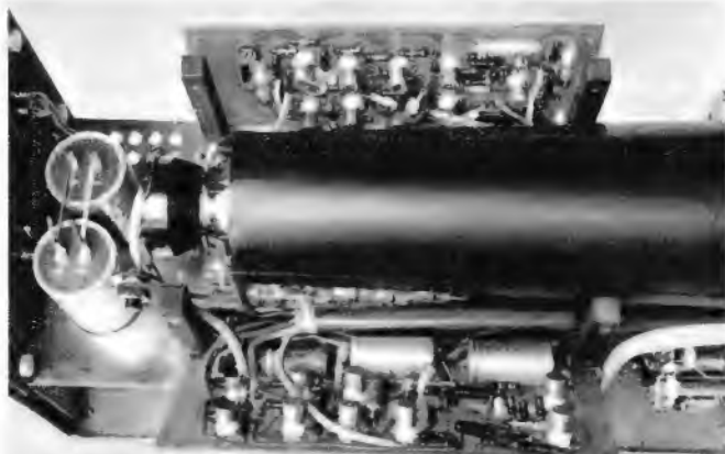
Bild 4. Die Platinen des Meßverstärkers und des Kippgerätes sind senkrecht zu beiden Seiten der Elektronenstrahlröhre montiert. Am oberen Bildrand befindet sich der Meßverstärker, am unteren Bildrand die Kippteilplatte
