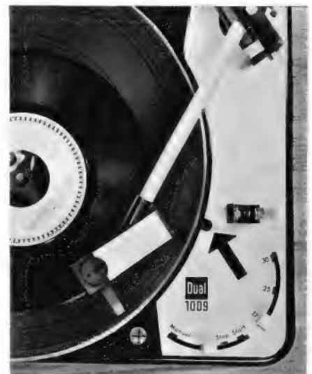
Bild 4. Die rechte Vorderseite des Plattenspielers mit der durch einen Pfeil markierten Schraube zum Justieren des Aufsetzpunktes
