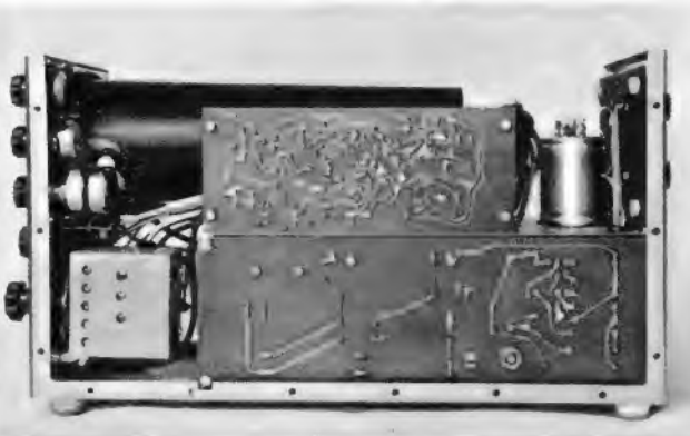
Bild 7. Seitenansicht mit Meßverstärker und darunter befindlicher zweiter Platine für das Stromversorgungsteil. An der Rückwand oberhalb des Chassis das Kühlblech mit dem Transistor OC 28 der Regelkaskade, davor, auf dem Chassis stehend, die Ladekondensatoren des Netzsteiles
