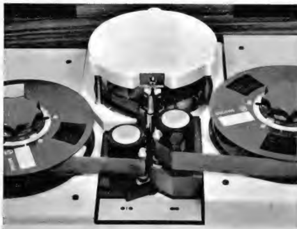
Bild 1. Magnetband-Aufzeichnungsgerät Philips-Video-Recorder 3400 für Bild und Ton von Fernsehdarstellungen. Das Gerät ist für vielseitige Anwendung im professionellen/kommerziellen Bereich gedacht
