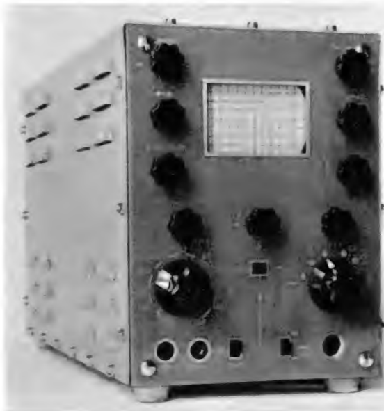
Bild 1. Gesamtsicht des Gerätes. Die Frontplatte mit der Beschriftung ist wie die Schaltung in gedruckter Technik hergestellt worden
